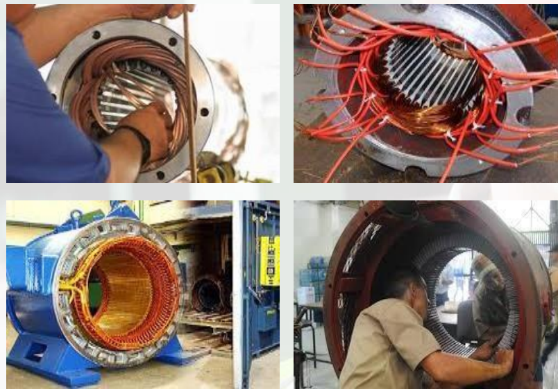
BOBINADOS MOTORES ELECTRICOS C.A/C.D
